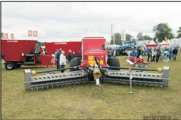
Maszyna do zbierania kamieni Stonebear o szerokości roboczej 5,2 m.
